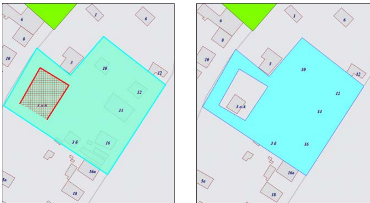
Рис. 142 Добавление в полигон пустоты
